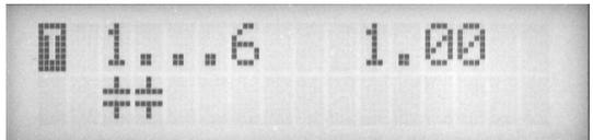
Mit ENTER wird der Menüpunkt "Programmierung von Feststufen" erreicht. Normalerweise sind alle Stufen für Automatikbetrieb programmiert (Werkseinstellung)
